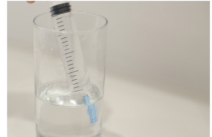
خطوة 6.3 املاً المحقنة بـ 10 مل من ماء صنبور أو ماء شُرب في درجة حرارة الغرفة.
